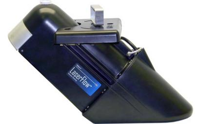
Le **LaserFlow** utilise un capteur ultrason pour mesurer le niveau afin de déterminer un point sous la surface pour mesurer la vitesse. Le capteur concentre alors son faisceau laser sur ce point et mesure le décalage de fréquence de lumière renvoyée. Le **LaserFlow** est idéal pour une large gamme d'applications de surveillance des eaux usées. Selon le type d'installation, Il est compatible avec le débitmètre **Teledyne Isco Signature** et aussi avec le module **LaserFlow 2160**.
